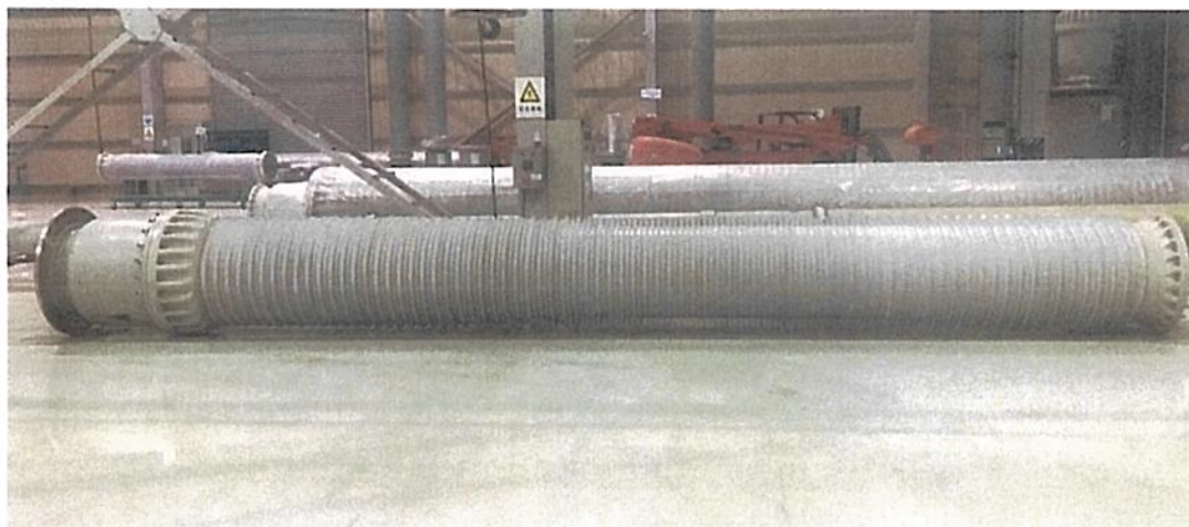
内压力试验后试品照片 Photograph 1
