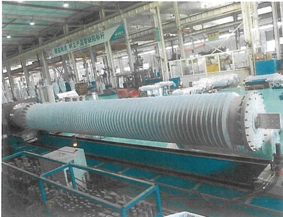
套管试验整体 Photograph 1
