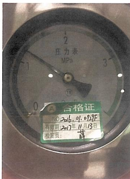
内压力试验表压 Photograph 2
